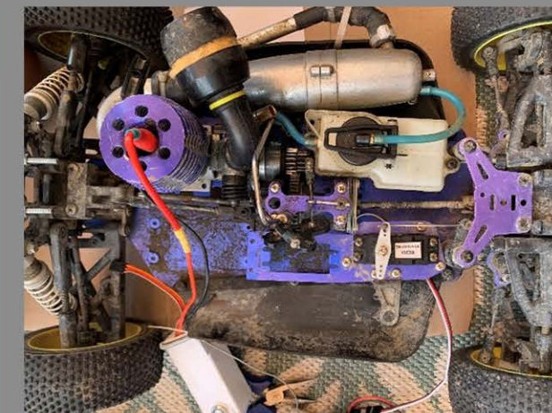
Fahrgestell mit eingebauten Motoren und Tank
