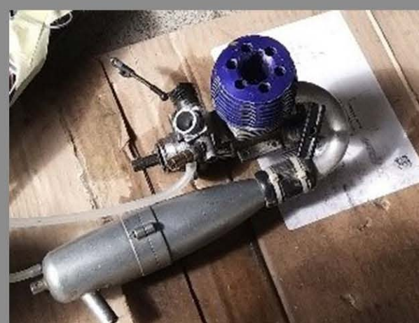
Nitromotor mit Auspuffanlage
