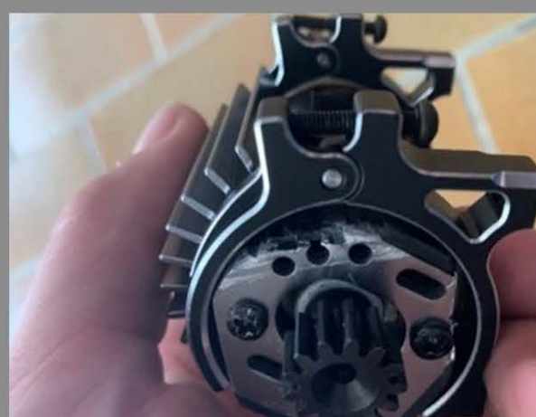
Elektromotor in der Halterung und mit angebrachtem Ritzel
